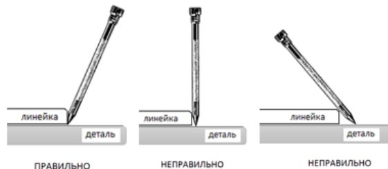
Рис.3. Расположение твердосплавного карандаша.
