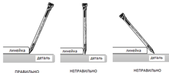
Рис.3. Расположение твердосплавного карандаша.
