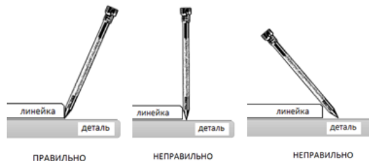
Рис.3. Расположение твердосплавного карандаша.
