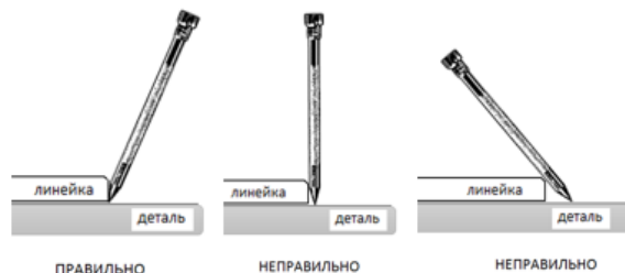
Рис.3. Расположение твердосплавного карандаша.
