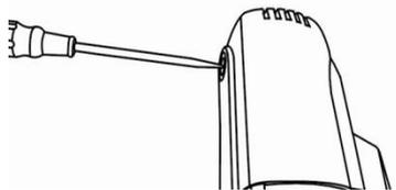
**ВНИМАНИЕ!** После замены угольных щеток обязательно убедитесь, что крышка правильно установлена на место. Для первичной притирки (обкатки) новых щеток подключите машину к сети, включите ее и позвольте ей работать в течение 10 минут без нагрузки, следя за работой инструмента.
