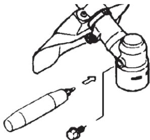
После 100 часов работы бензотриммера проверьте состояние глушителя и выхлопные трубы. Для этого снимите защитный кожух и удалите с помощью растворителя или бензина образовавшийся нагар и налипший мусор.
