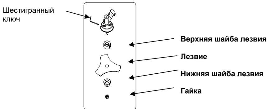
4. Открутите гайку по часовой стрелке (в правую сторону) и снимите нижнюю шайбу лезвия.
