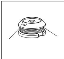
1. Прикрутите нейлоновую катушку против часовой стрелки (в левую сторону) по резьбе на выходном валу редуктора.
