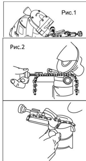
2. Цепь уложите на направляющие правильным образом: так, чтобы режущая часть цепи была направлена в сторону абразивного диска (5). Рис. 1.
