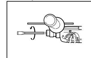
ограничитель на такое расстояние между концом ограничителя и концом бура, которое соответствует нужной глубине сверления. Затем затяните винт фиксации ограничителя глубины сверления.
