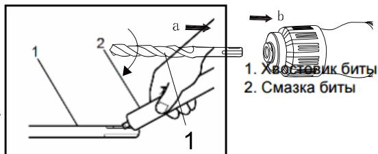
перемещения. Это приводит к эксцентричности, когда машина не загружена. Однако сверло автоматически центрируется при вращении. Перед установкой оснастки ее необходимо очистить от пыли. Для увеличения срока эксплуатации и уменьшения износа необходимо нанести специализированную смазку на шлицы оснастки (примерно 0,5 - 1 г).
