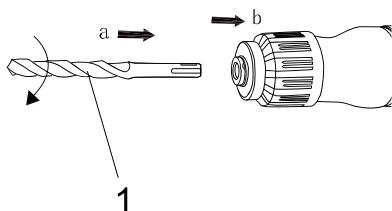
Проверьте надежность фиксации, потянув бур на себя.
