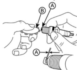
Обслуживание свечи зажигания А-зазор, В-щуп.
