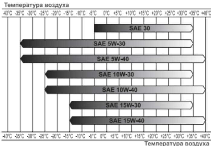
**Заправка маслом двигателя новой газонокосилки**
