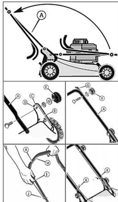
газонокосилки, возьмите травосборник за ручку и зацепите крючки травосборника за ось задней крышки.
