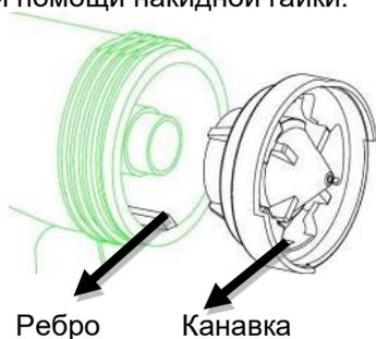
Ребро соединения должно войти в канавку насадки.
