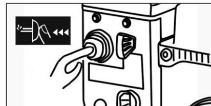
7. Запустить двигатель с помощью стартера.
