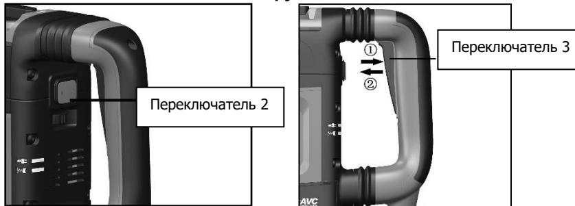
**Существует два способа включения машины только в режиме молотка:**
