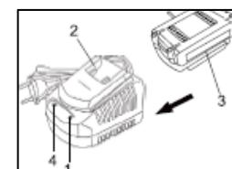
**ВНИМАНИЕ!** Чтобы сохранить работоспособность Li-Ion батареи, она не должна заряжаться при температуре ниже 0°C или выше 45°C. Если температура аккумуляторной батареи выше 45°C или ниже 0°C, процесс заряда батареи не произойдет. При этом индикатор (1) будет гореть зеленым после подключения зарядного устройства к батарее. Если аккумуляторная батарея повреждена, процесс заряда батареи не произойдет. При этом индикатор (1) будет гореть зеленым после подключения зарядного устройства к батарее.
