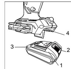
аккумуляторной батарее выше 45°C или ниже 0°C, процесс заряда батареи не произойдет. При этом индикатор (1) будет гореть зеленым после подключения зарядного устройства к батарее. Если аккумуляторная батарея повреждена, процесс заряда батареи не произойдет. При этом индикатор (1) будет гореть зеленым после подключения зарядного устройства к батарее.
