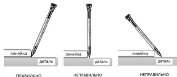
Рис.2. Нанесение линий: а — наклон твердосплавного карандаша в сторону от линейки; б — по направлению перемещения твердосплавного карандаша.
