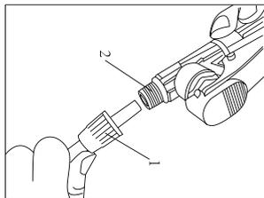
Соедините распылитель и рычаг подачи. Поверните стопорную гайку (1) чтобы зафиксировать их.
