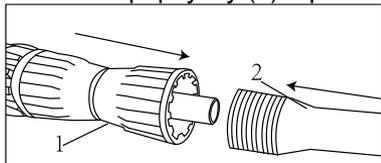
Соедините распылитель и рычаг подачи. Поверните стопорную гайку (1) чтобы зафиксировать их.
