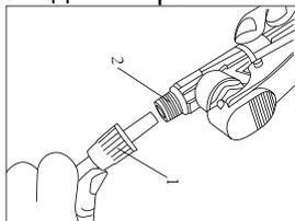
**ВНИМАНИЕ!** Диаметр распылителя с двух концов разный. Конец с большим диаметром крепится к рычагу подачи, а меньшим к форсункам.
