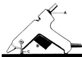
Держа пистолет за ручку одной рукой, возьмите опорную скобу другой рукой (С) и нажмите на пистолет вниз и вперед, чтобы пистолет зафиксировался на опорной скобе в положении наиболее близком к соплу.
