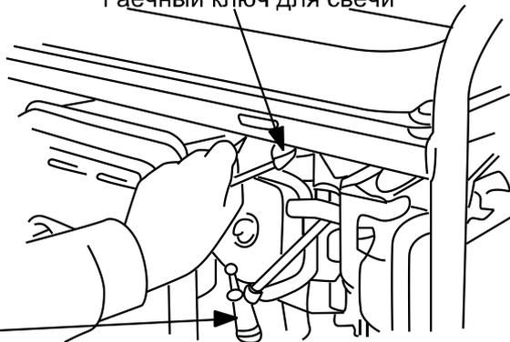
Колпачок свечи зажигания
