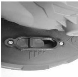
Для большего удобства работы в углах, Вы можете снять сегмент от шлифовальной платформы. Подключите машину к основному источнику питания.
