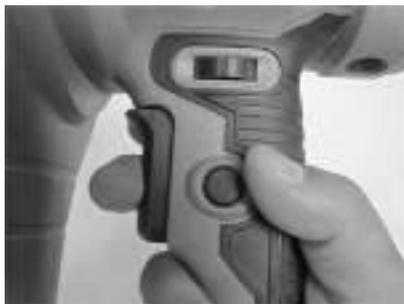
Данная модель оснащена регулятором скорости, Вы можете вращать регулятор, чтобы настроить желаемую скорость.
