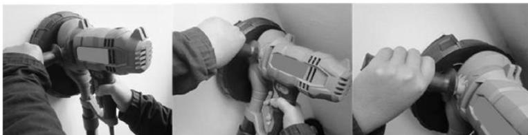
Нажмите кнопку пуска, чтобы запустить машину. Вы можете нажать кнопку блокировки, чтобы заблокировать выключатель для длительного использования. Если вам нужно отпустить выключатель, нажмите на кнопку пуска, а затем отпустите ее.
