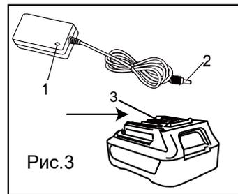
**ВНИМАНИЕ!** Чтобы сохранить работоспособность Li-Ion батареи она не должна заряжаться при температуре ниже 0° С или выше 45° С. Если температура аккумуляторной батареи выше 45° или ниже 0° С, процесс заряда батареи не начнется. При этом индикатор (1) будет гореть зеленым после подключения зарядного устройства к батарее.
