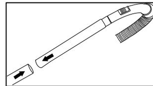
4. Плотно вставьте стальную телескопическую трубку во всасывающую щетку для пола. Если необходимо заменить одну щетку на другую, снимите используемую щетку и наденьте вместо нее другую.
