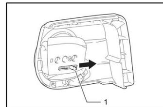
3. Установите боковую крышку (1) на шину (2), убедитесь, что натяжитель попал в отверстие (3) на шине (2).
