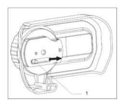
4. Установите боковую крышку (1) на шину (2), убедитесь, что натяжитель попал в отверстие (3) на шине (2).
