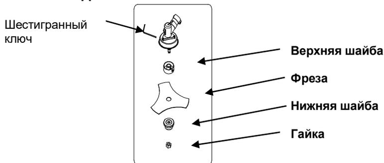
4. Открутите гайку по часовой стрелке (в правую сторону) и снимите нижнюю шайбу лезвия.
