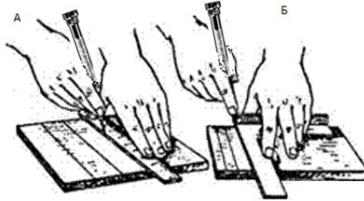
Рис.4. Нанесение линий: а — перпендикулярных; б — параллельных
